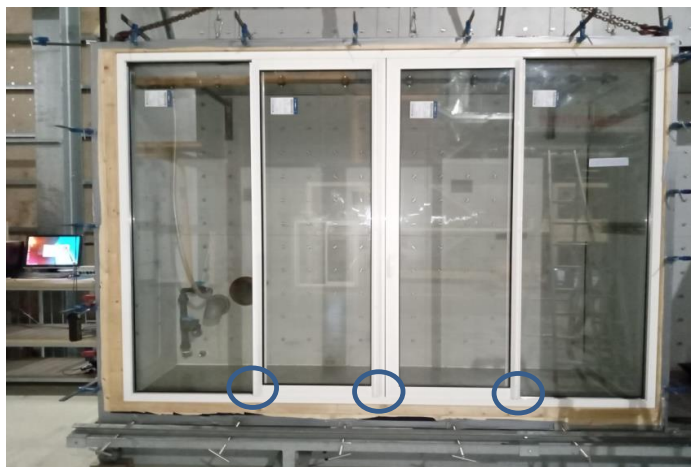
Localização dos pontos onde se identificaram as fugas de ar mais significativas
