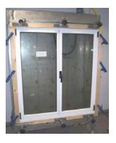
Normas de classificación: NF-EN 12207:2000. Fenètres et portes. Étanchéité à l'air.
