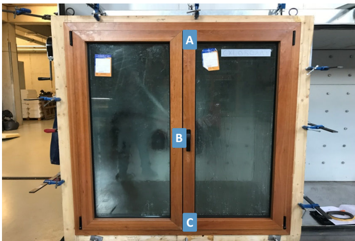
Localização dos pontos onde se mediram as deformações
