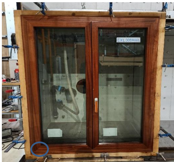
Identificação dos pontos onde se verificou a perda de estanquidade do provete
