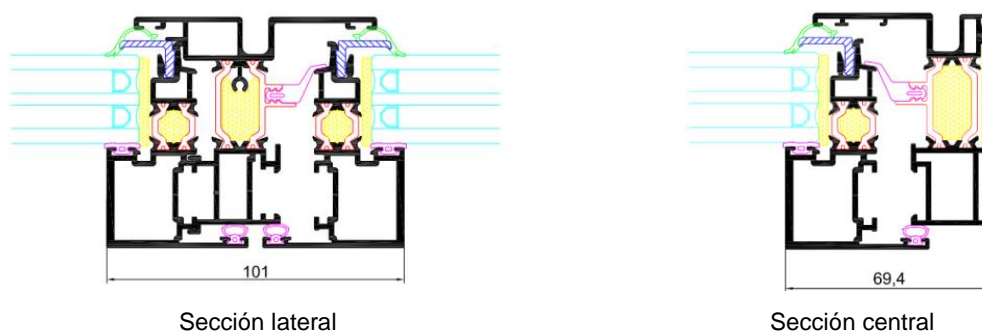
Figura 1: Esquema representativo de los perfiles del Sistema AJi – Hoja Oculta Canal CE de Anicolor (dimensiones en mm).
