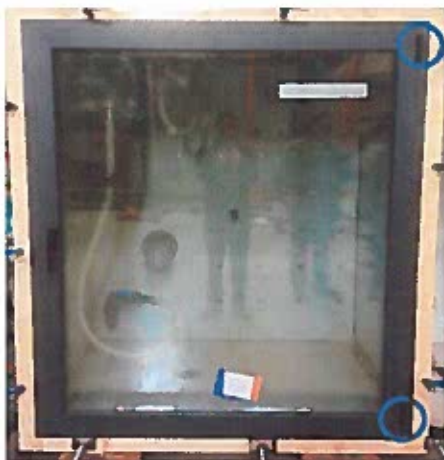
Localização dos pontos onde se identificaram as fugas de ar mais significativas
