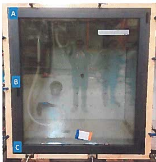
Localização dos pontos onde se mediram as deformações
