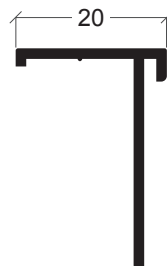
Y-24 Remate p/ apanelado Solape p/ precerco
