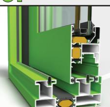
Sistema de correr com 105mm fixo e moveis perimetrais ou de corte reto, rotura térmica, com poliamidas de 30 mm no aro fixo e 14,6 mm no aro móvel.
