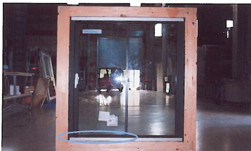
Identificação dos pontos onde se verificou a perda de estanquidade do provete
