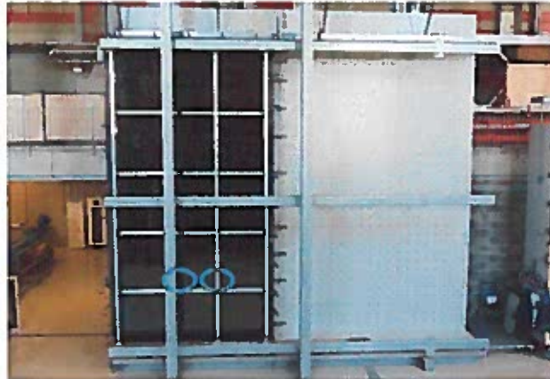
Localização dos pontos onde se identificaram as fugas de ar mais significativas, nos painéis móveis
