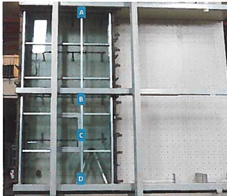
Localização dos pontos onde se mediram as deformações
