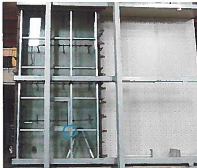
Identificação dos pontos onde se verificou a perda de estanquidade do provete
