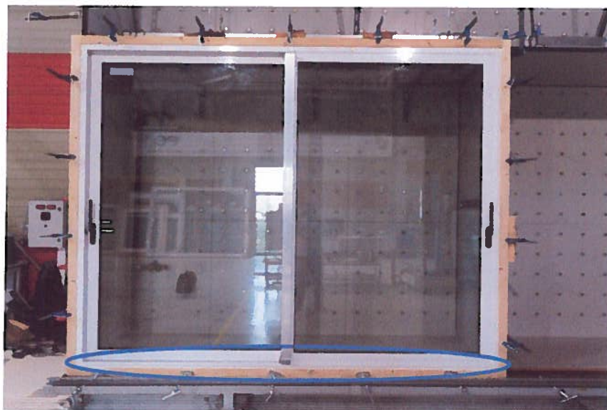
Identificação dos pontos onde se verificou a perda de estanquidade do provete
