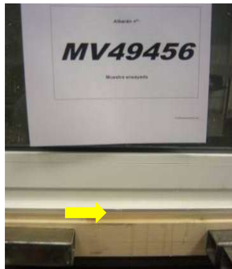
Zona filtración de agua
